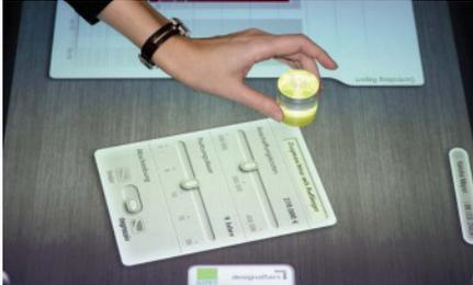
Abb 6: Das Bedienpanel folgt stets der Position und dem Drehwinkel des Zylinders
