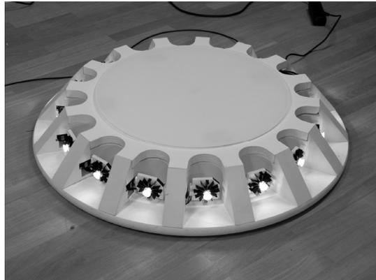
Abbildung 1: Hardware Maskenrad, Trittfläche und bewegbare RGB LEDs
