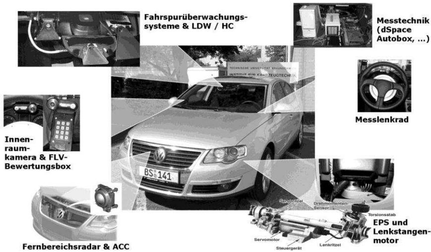
Abbildung 1: Experimentalfahrzeug mit Messtechnik und Sondereinbauten
