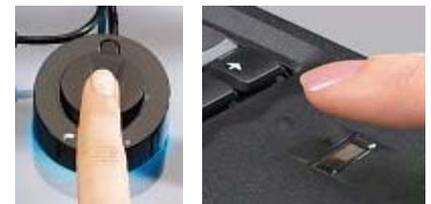
Abb 3: Fingersensoren (Bild: Visortech, Acer)
