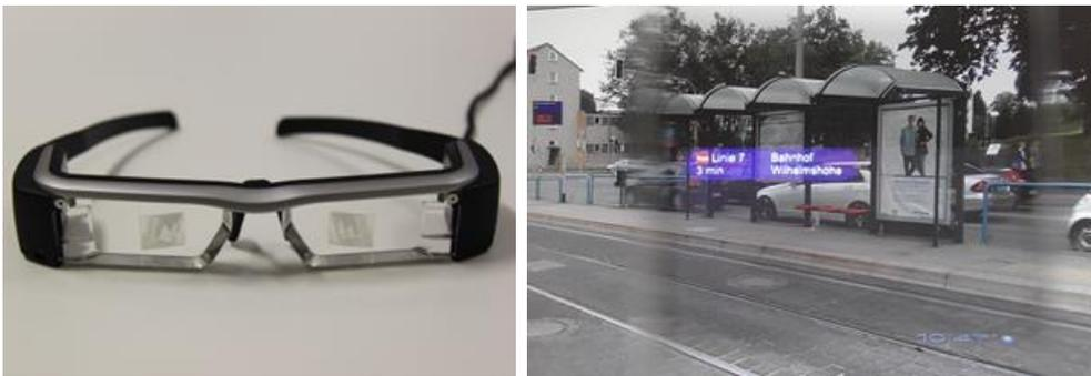
Abbildung 2: Durchsichtdatenbrille Epson Moverio BT-200 (links) und exemplarische Einblendung von Reiseinformationen in der Brille (rechts)
