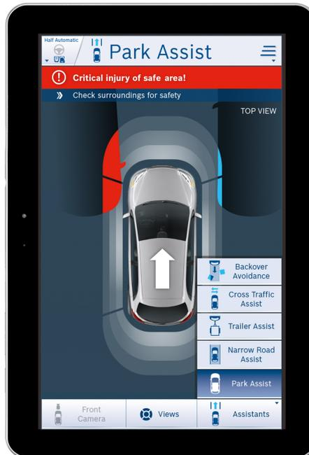
*Bild 1: Graphical User Interface Design für einen aktiven Einparkvorgang mit Darstellung einer kritischen Situation und aufgeklapptem Menü für weitere Assistenz-Funktionen.*
