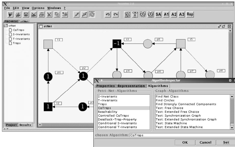
In Abbildung 5 ist der Deadlock bestehend aus den Stellen  $p_1$ ,  $p_2$  und  $p_3$  markiert (die Stellen sind schwarz unterlegt und mit '1' gekennzeichnet). Die Werte innerhalb der Transitionen  $t_2$  und  $t_3$ , '1' und '-1' entsprechend, geben den Defekt dieser Transitionen bezüglich des angezeigten Deadlocks an. Mit Hilfe des Inspektors für Algorithmen können entweder Berechnungen direkt angestoßen oder diese den konfigurierbaren Schaltflächen der Toolbar zugeordnet werden.
