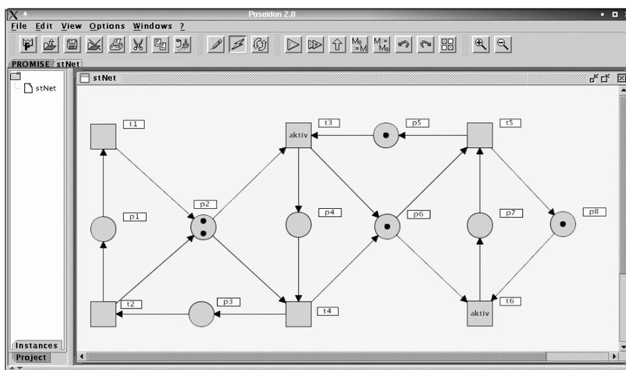
Abbildung 4 zeigt den Simulator für S/T-Netze. Unter der dargestellten Markierung sind die Transitionen  $t_3$  und  $t_6$  aktiviert. Der Simulator kann sowohl über die Tastatur als auch mit den Simulator-spezifischen Bedienelementen in der Toolbar gesteuert werden.
