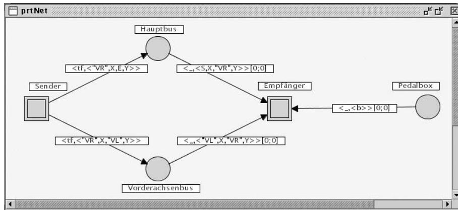
Abbildung 7 zeigt die abstrakte Sicht der Steuerungseinheit VR. Auf dieser Abstraktionsebene werden innerhalb einer verteilten Komponente Sende- und Empfangseinheiten unterschieden, die in der graphischen Darstellung wiederum durch Supertransitionen repräsentiert sind.
