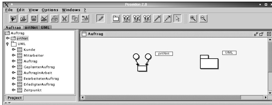
Abbildung 1 stellt die oberste Ebene des Projektes “Auftrag” dar. Dieses Projekt besteht aus einem Pr/T-Netz und einem UML-Klassendiagramm. Der im linken Bereich gegebene Baum zur Projektnavigation beinhaltet Repräsentanten für die verschiedenen Klassen der statischen Projektsicht. In der Toolbar werden Werkzeuge zur Verfügung gestellt, die u.a. die Möglichkeit bieten innerhalb des betrachteten Projektes weitere UML-Klassendiagramme und Netzmodelle anzulegen.
