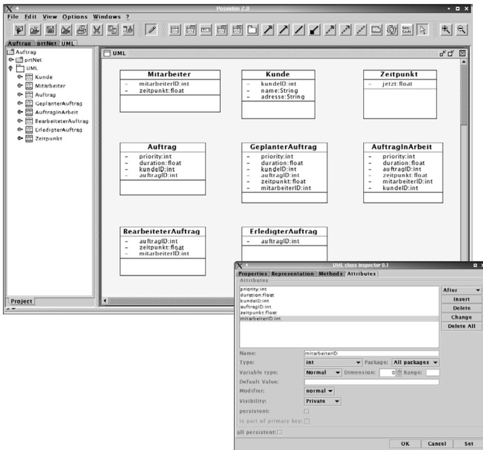
Abbildung 3 gibt einen Überblick über die Typisierung der Stellen im betrachteten Anwendungsbeispiel der Auftragsbearbeitung. Die Typdefinition erfolgt unter Verwendung eines Editors für UML-Klassendiagramme, wobei die spezifischen Eigenschaften der einzelnen Klassen mit Hilfe von Inspektoren editiert werden.
