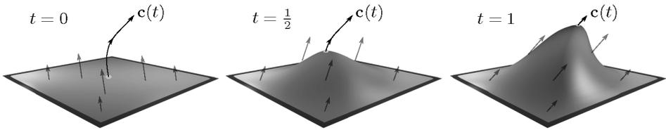
Abbildung 1: Kontinuierliche Vektorfeld-basierte Deformation. Eine kleine Griffregion (\*) wird kontinuierlich entlang einer vom Benutzer vorgegebene Leitkurve  $c(t)$  bewegt, während der Rand (•) der Oberfläche fixiert bleibt. Für jeden Integrationsschritt zum Zeitpunkt  $t$  ist die aktuelle Oberflächengeometrie und die erzwungenen Vektoren (•) gegeben, während das übrige Vektorfeld (•) berechnet werden muss, bspw. durch eine globale Energieminimierung.
