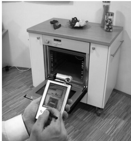
Abbildung 2: Auf einen PDA wird in das reale Bild der Küchenzeile ein virtueller Einzelaustrag eingeblendet
