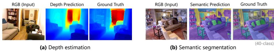
Abb. 1: Vorhersagen des Fully Convolutional Residual Network (FCRN) bei den Aufgaben (a) Tiefenschätzung und (b) semantische Segmentierung.
