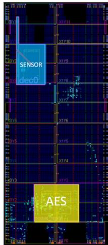
Abb. 6: Flurplan eines Spartan-6 FPGA in dem ein Angreifer einen Sensor betreibt, um die Spannungsschwankungen des AES Moduls zu messen. Ergebnisse dazu sind in Abbildung 8 gezeigt.
