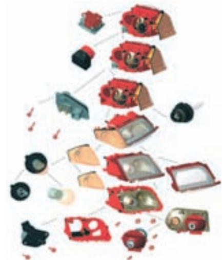
Abbildung 2 links: Roboter spielt Jenga; rechts: Automatisch generierter Montagebaum
