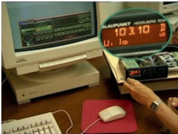
Bild 2: Das „Herz“ des Autoradios wurde in eine Workstation verpflanzt, wo es bequem erprobt und weiterentwickelt werden kann
