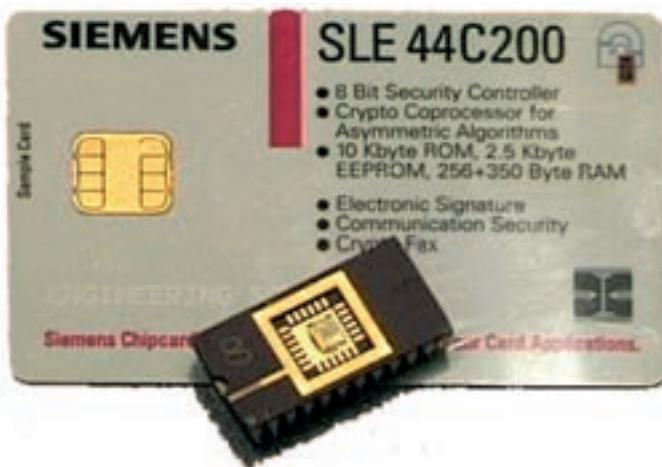
Bild 1: Der Krypto-Prozessor auf der Chipkarte erlaubt eine abhörsichere Kommunikation und eine fälschungssichere elektronische Unterschrift
