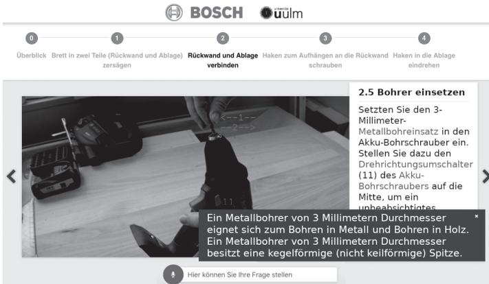
Abb. 2: ROBERT erklärt deinem Nutzer wie er einen 3mm Metallbohrer erkennt und diesen in die Bohrmaschine einsetzt.
