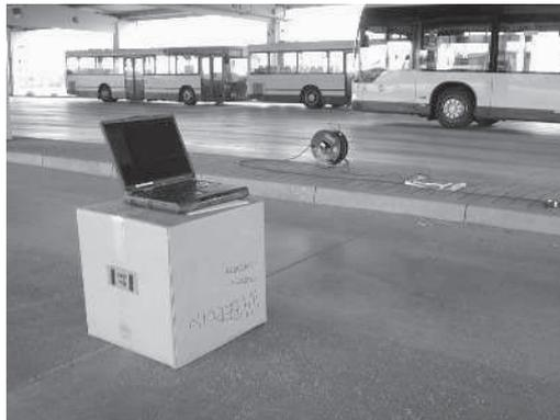
Abbildung 1: Messungen im Busbahnhof Potsdam. Hier werden Ortungslösungen zur effizienten Parkraumplanung für die über Nacht abgestellten rund 120 Busse benötigt. Nur bestimmte Parkanordnungen erlauben die Ein-/Ausfahrt entsprechend der Fahrpläne. Satellitengestützte Positionsbestimmung ist wegen der Signalabschirmung durch die Überdachung ungeeignet.
