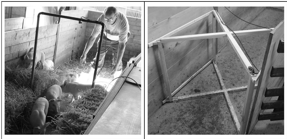
Abbildung 2: Eindimensionale Antenne (links), zweidimensionale Antenne (rechts)
