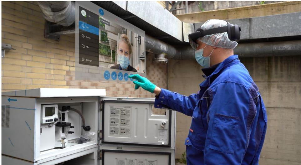
Abb. 1: Nutzung der Microsoft HoloLens 2 und die App Remote Assist (teilweise Überblendung der Außen- und der Innenansicht mit Overlay-Einbettung im Nutzersichtfeld) - siehe Aufzeichnung<sup>4</sup>
