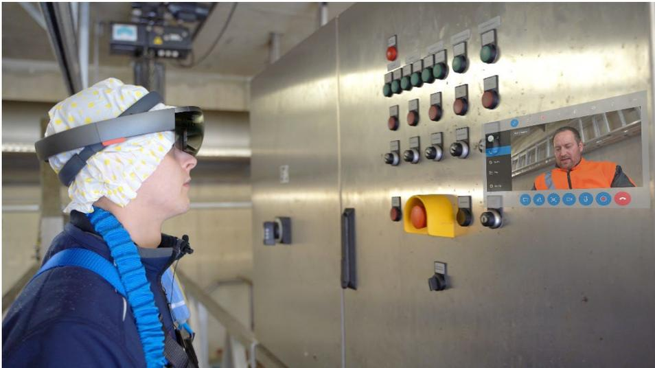
Abb. 2: Nutzung der Microsoft HoloLens 1 und die App Remote Assist (teilweise Überblendung der Außen- und der Innensicht; mit Overlay-Einbettung im Nutzersichtfeld)
