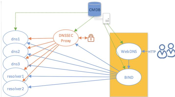
Abb. 2: Am LRZ verwendetes DNSSEC Signing Proxy Konzept mit BIND Nameservern. Die technischen Details sind in [Re15a] beschrieben.
