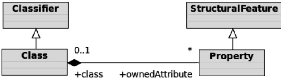
Bild 3: Ausschnitt aus dem Metamodell der UML 2.3: Metaklassen Class und Property (in Anlehnung an [UML10])
