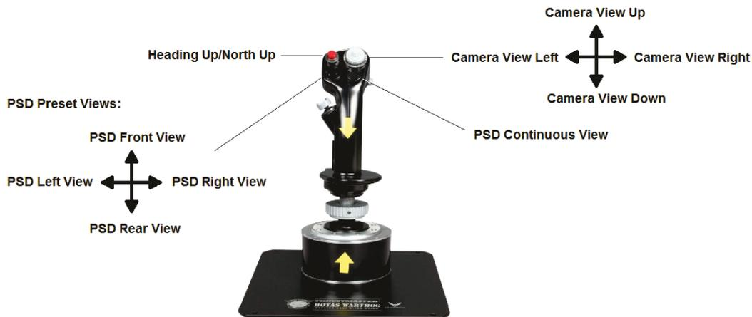
Bild 7: Steuerknüppel mit Tasten zur Steuerung der Sichtachse von PSD und Bordkamera
