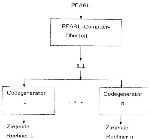
Der Compiler-Oberteil und die Codegeneratoren sind in GBL1, einem PL/I-Subset, programmiert. Für diesen PL/I-Subset steht ebenfalls ein Compiler-Oberteil GBL1 → IL1 zur Verfügung. Mit seiner Hilfe und dem entsprechenden Codegenerator werden der PEARL-Compiler-Oberteil und der Codegenerator selbst in den Zielcode (Assembler oder BR) des Zielrechners übersetzt.
