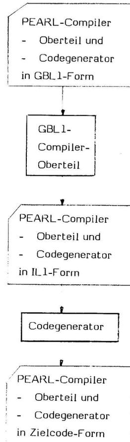
Der PEARL-Compiler kann also auf dem Zielrechner installiert werden, ohne daß dieser über einen PL/I-Compiler verfügt.
