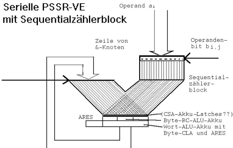
Abbildung 2: Blockschemata einer Serialzähler-Verarbeitungseinheit
