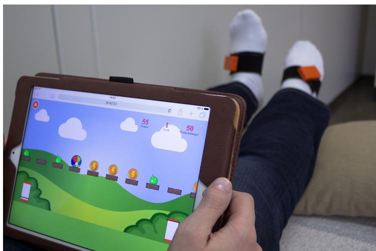
Abbildung 1: Das jumpBALL System. Zwei drahtlose Sensoren erfassen die Fußbewegungen. Indem der Benutzer die Muskel-Venen-Pumpe im rechten und linken Fuß durchführt, steuert er das Spiel auf dem Tablet.
