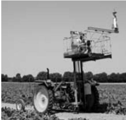
Abbildung 1: An dem abgebildeten Traktor ist eine Plattform angebracht, an der der Laserscanner montiert ist. Der Aufbau besteht aus dem Laserscanner selbst, der Digitalkamera und dem DGPS.
