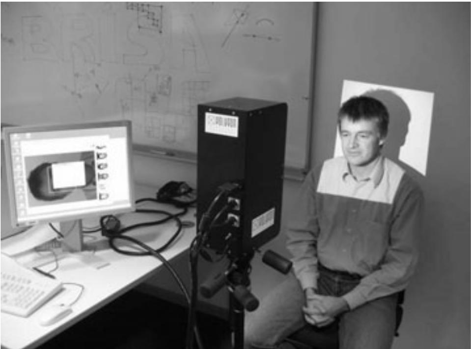
Abbildung 1: Aktives Aufnahmesystem zur dreidimensionalen Vermessung des Gesichtes
