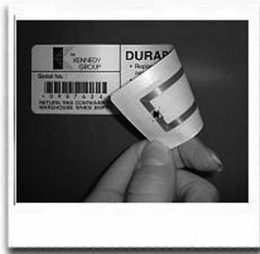
Abbildung 2: RFID-Chip (Quelle: The Kennedy Group)
