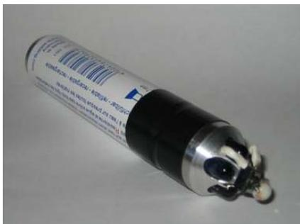
Abb.1: IR-Stift mit druckempfindlicher Spitze (Stift 2)
