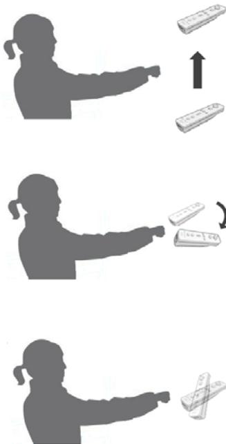
Abb. 5: Oberes Bild: Wii-Remote mit Koordinatensystem, zweites Bild von oben: translatorische Bewegung in z-Richtung, zweites Bild von unten: Rotation nach rechts, unteres Bild: Kippbewegung nach oben
