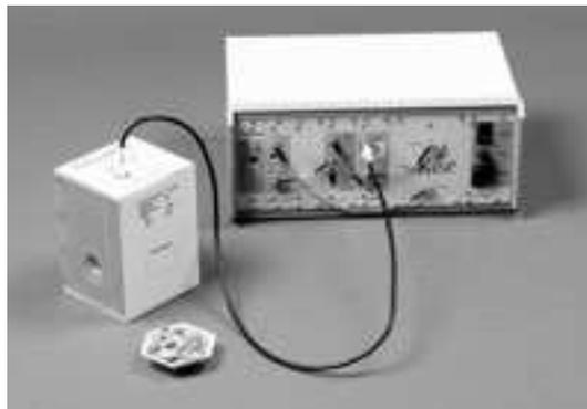
Abbildung 1: Realisierter NMR-Agro-Sensor bestehend aus Messspule und Kea<sup>®</sup>-Spektrometer. Die Proben werden in einem Probenröhrchen von 115 mm x 30 mm der Messspule zugeführt.
