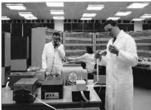
Abbildung 2: BESM 6 im Willersbau der TU Dresden, Eingabe über Lochkarten, Ausgabe über Lochstreifen zur Simulation und Optimierung von Klima- und Kälteanlagen mit dem Blockorientierten Simulations-System BORIS 1
