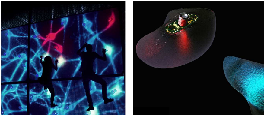
Abbildung 1: Links: Interaktive Kletterwand mit dem Spiel „Psycho Path“, rechts: Interaktive Klettersteine mit Platinen, LEDs, Touch-Sensoren und Antennen
