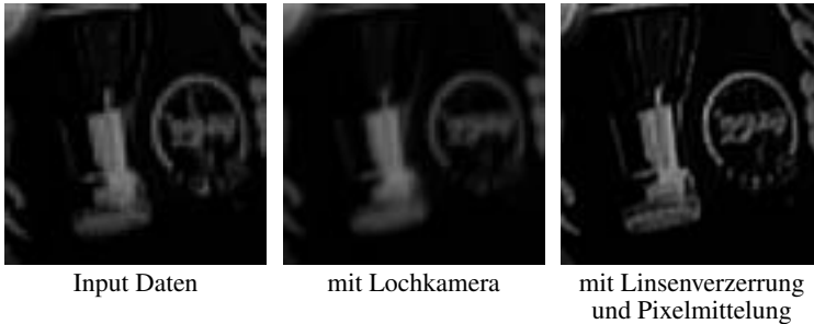
Abbildung 6: Für scharfe Layerbilder müssen Details des Bildformierungsprozesses modelliert werden.
