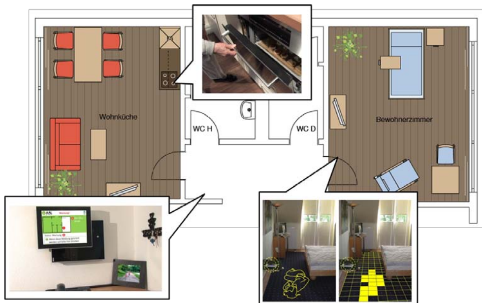
Abbildung 1: Aufbau des Living Labs mit beispielhaften Diensten (u.a. Touchterminal am Eingang, TV-Interaktionssystem, Sensorboden zur Sturzerkennung, Ofen-Überwachung)
