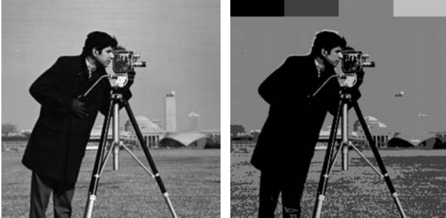
Abbildung 5: Quantisierung beim Bild Kameramann. Links: 256 Grauwertstufen. Rechts: 4 Grauwertstufen, mit deutlichem Effekt auch auf den Teststreifen.
