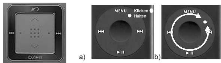
Abbildung 1: links Samsung Touch & Click / rechts iPod ClickWheel (animierte Hilfe) a) klicken und halten b) drehen
