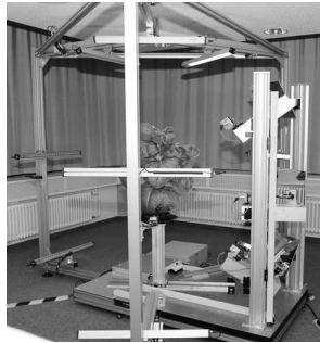
Abbildung 2: Realisiertes Messsystem für Tabak-Pflanzen
