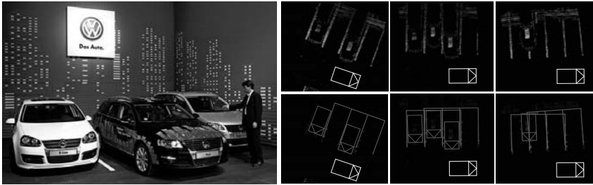
Abbildung 8: Ergebnisse für das Szenenverstehen intelligenter Fahrzeuge: Versuchtsträger Paul (links), Eingangsdaten als Draufsicht (rechts oben), Beispielergebnisse (rechts unten).
