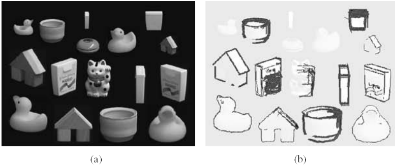
Abbildung 5: Beispielresultat für die rotations- und skalierungsunabhängige Erkennung von verschiedenen Objekten: (a) Eingangsbild (b) Erkannte Objekte in rot/blau hervorgehoben.
