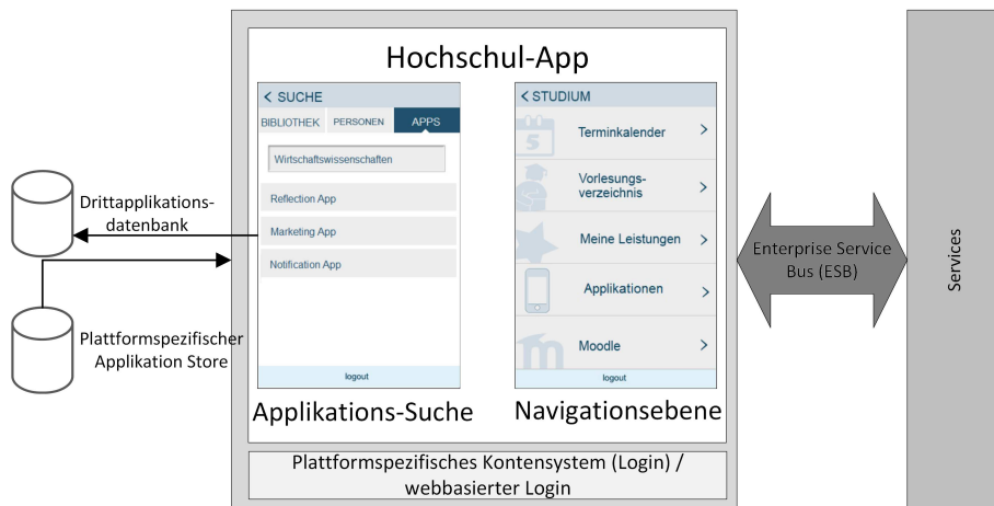
Abbildung 2: Systemarchitektur des Hochschul-App Frameworks, bestehend aus den Applikationsdatenbanken, der Hochschul-App und der Service-Schicht.
