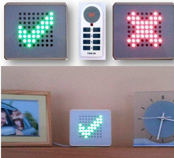
Abbildung 3: Das Monitoring Control System besteht aus einer Fernbedienung (Oben Mitte), mit deren Hilfe der Nutzer die Verarbeitung seiner personenbezogenen Daten aktivieren oder deaktivieren kann. Das Display (oben links und rechts, sowie unten) zeigt den Status der Datenverarbeitung an.
