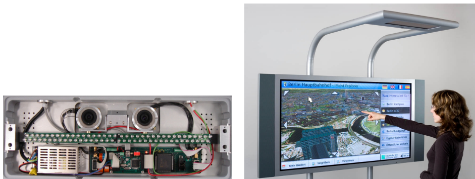
Abbildung 1&2: Handtracker-Hardware mit Stereo-Kameras, Gesamtsystem mit POI-Applikation
