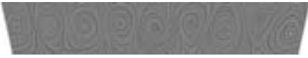
(a) Die Visualisierungsmethode der Linienintegraleffaltung stellt Wirbel bildlich dar, jedoch ist eine Messung ihrer Eigenschaften nicht möglich.
