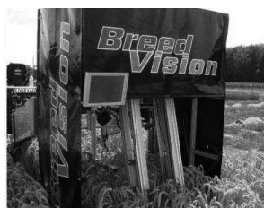
Abbildung 1: Integration des Lichtgitters in den Phänotypisierungsplattformen für Feldmessungen in Mais (BoniRob links) und in Triticale (BreedVision rechts)
