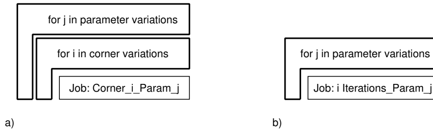
Bild 2. Generierung der Simulationsjobs für Corner Analyse und MC Analyse. a) Bei der Corner Analyse wird je Kombination, bestehend aus Prozess-Corner i und Einsatzbedingung j , ein Simulationsjob gebildet. b) Weil die MC Analyse im Simulator implementiert ist, erfolgt die Iteration des Prozesses i im Simulationsjob selbst. Es ist lediglich pro Einsatzbedingung j ein Simulationsjob notwendig.
