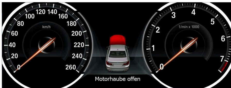
Abbildung 1 - Motorhaube offen - Checkcontrol Meldung im freiprogrammierbaren Kombiinstrument.
