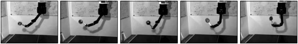
Abbildung 1: Diese Abbildung illustriert die Verallgemeinerung eines Rückhand-Motor-Primitives. Der Roboter verwendet jeweils dasselbe Motor-Primitiv, um auf Bälle an unterschiedlichen Positionen mit unterschiedlichen Geschwindigkeiten zu reagieren. Hierfür werden nur die Meta-Parameter des Motor-Primitives angepasst.
