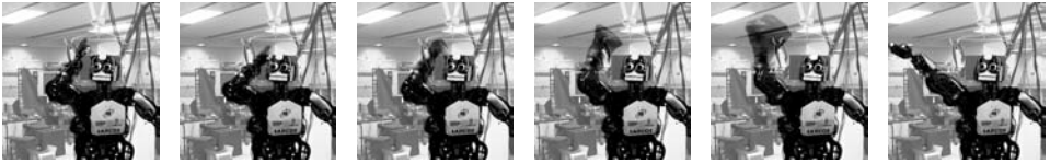
Abbildung 4: Diese Abbildung illustriert einen Dart-Wurf mit dem Humanoiden JST-ICORP/SARCOS CBi. Der Roboter hat die Aufgabe, einen gelernten, erfolgreichen Wurf so zu verallgemeinern, dass alle Felder auf der Dartscheibe zuverlässig getroffen werden können.
