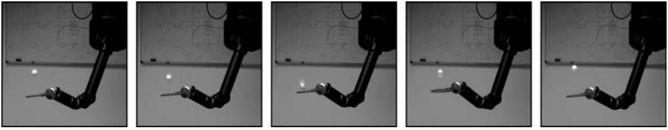
Abbildung 6: Diese Abbildung illustriert die gelernte Tischtennisball-Jonglier-Fähigkeit. Die Aufgabe ist es, den Ball auf dem Schläger hüpfen zu lassen. Hierzu musste der Lernalgorithmus bestimmen, welche Motor-Primitive Vorrang haben, z. B. ob es wichtiger ist, den Ball genau mit der Mitte des Schlägers zu treffen oder mit der richtigen Orientierung.
