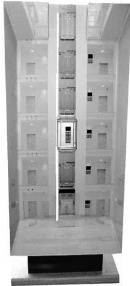
Abbildung 5.1: Modell einer Aufzugsteuerung
