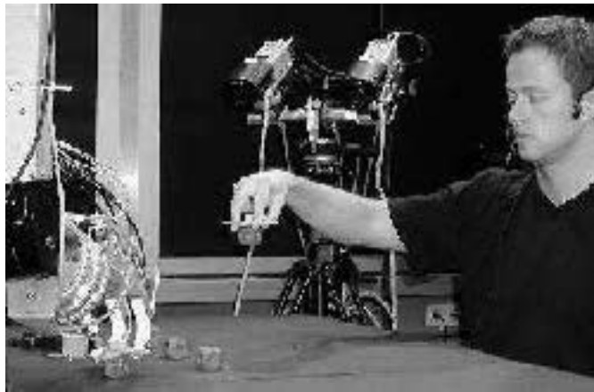
Abbildung 7: Angestrebtes Imitationsszenario und nach dem Vorbild menschlicher Griffposturen eingestellte, "wirkungsäquivalente" Posturen der Roboterhand des GRAVIS-Systems.
