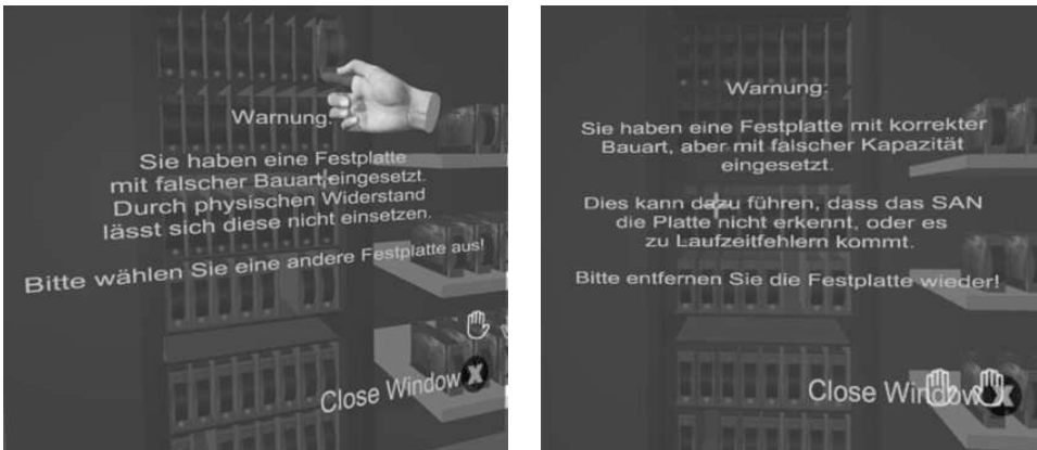
Abb. 9: Fehlermeldungen bei Einsetzen falscher Festplatten
