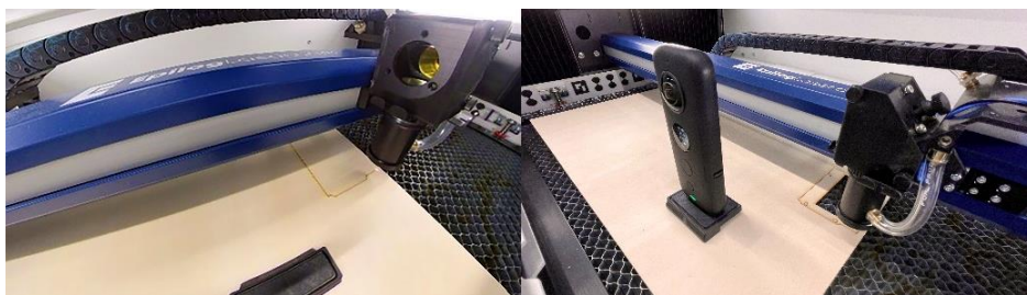
Abb. 1: 360-Grad-Aufnahme und Position der Actioncam im Innerraum des Lasercutters
