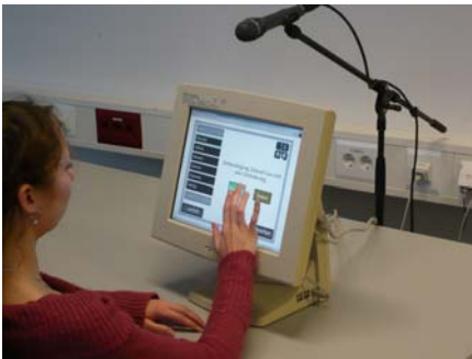
Abb. 2: Die Zieleingabe wurde multimodales Interface auf einem 15 Zoll Touchbildschirm umgesetzt
