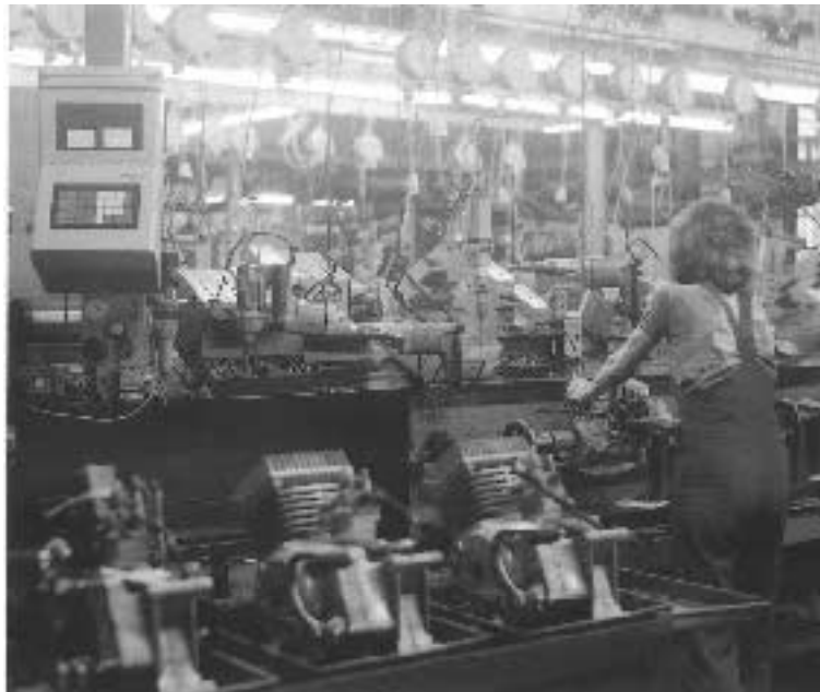
Abbildung 13: Das Betriebsdatenterminal K 8902 in der Motorenfertigung
